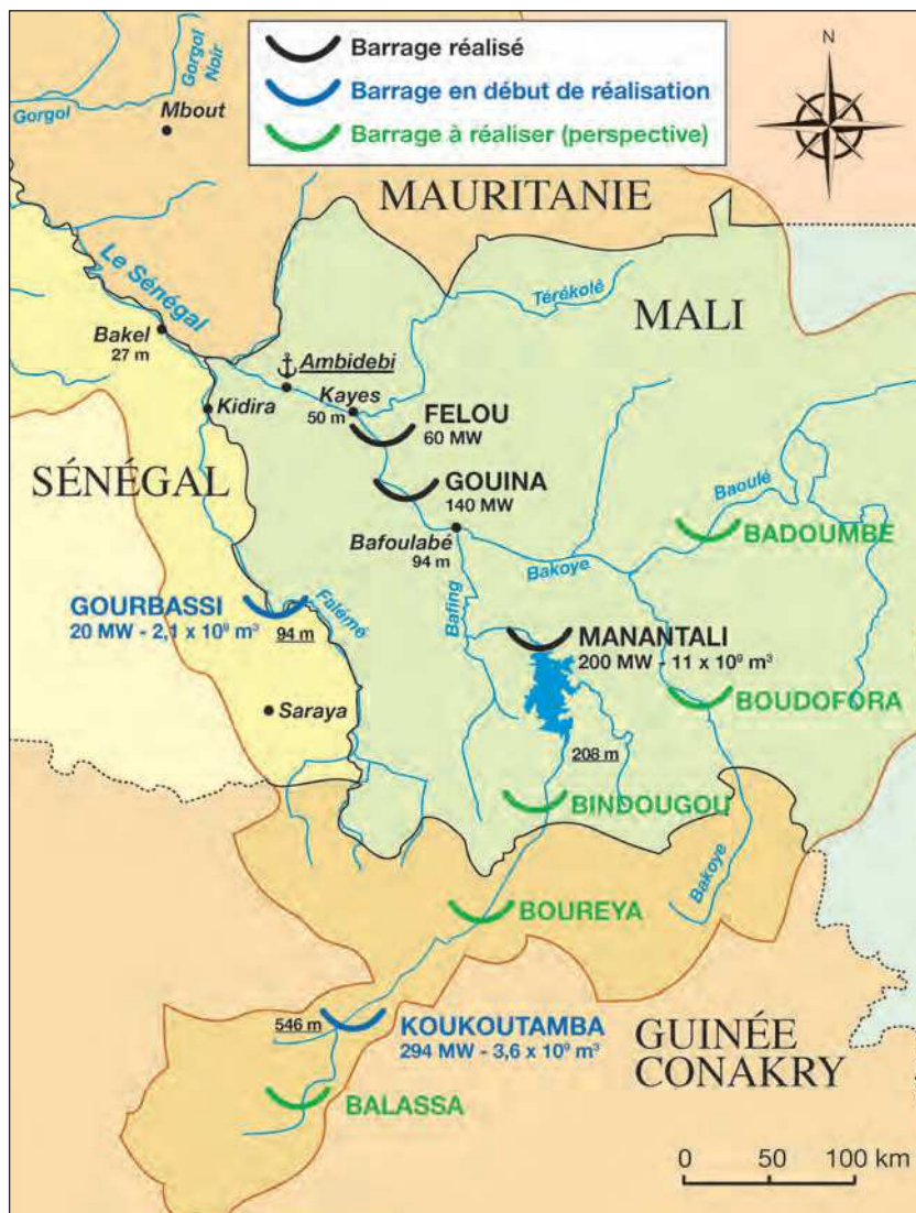
Figure 10. Aménagement complet de la haute vallée du Sénégal. Source figure originale (G. Crevola) d'après documents OMVS.
