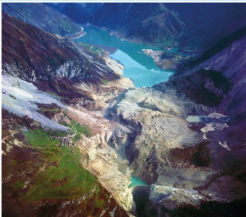
Fig. 12 : Catastrophe du Vajont. La masse glissée à rempli en partie le lac de retenue, le scindant en deux parties ; le barrage-voûte est resté intact.
